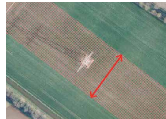
Afbeelding: bovenaanzicht belaste strook bij bovengrondse hoogspanningsverbinding (streeparcering)
